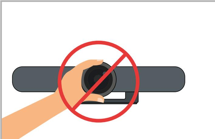
Nunca intente regular el enfoque de la cámara en forma manual porque destruirá el equipo. Siempre debe hacerlo desde el control remoto o desde la aplicación instalada en la computadora o el celular.
